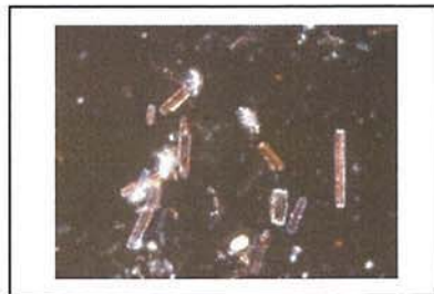
アソフィライト (屈折率 n_D^{25^\circ C} : 1.618 )
