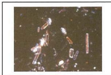
アンソフイライト (屈折率 n_D^{25^\circ C} : 1.618 )
