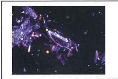
クリソファイト (屈折率 n_D^{25^\circ C} : 1.550 )
