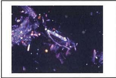
クリソタイル (屈折率 n_D^{25^\circ C} : 1.550 )
