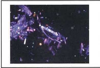
クワーツ (屈折率 n_D^{25^\circ C} : 1.550 )
