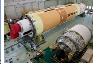
H-IIBロケット (三菱重工飛島工場での組立の様子)
