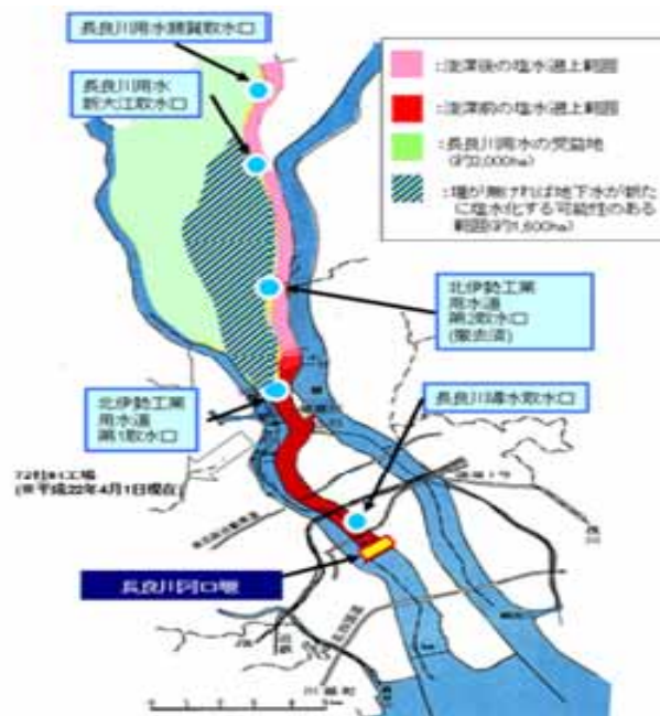
図4 - 9 浚渫による塩水の遡上と地下水の浸透
