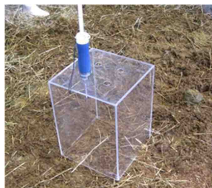
図1 検知管による悪臭物質の測定
