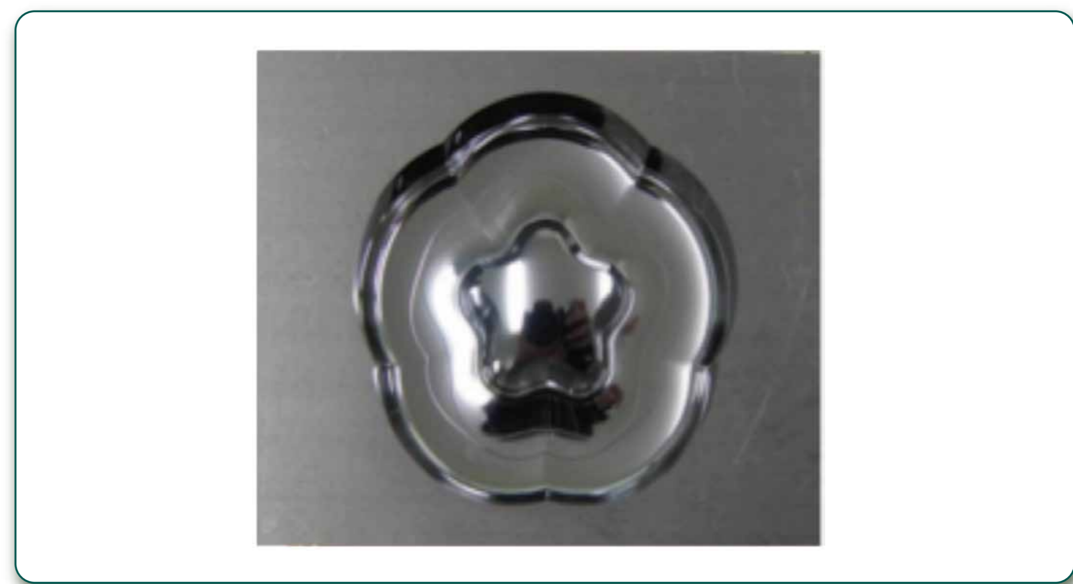
図2 すでに達成した金型鋼への磨きレス自由曲面加工
