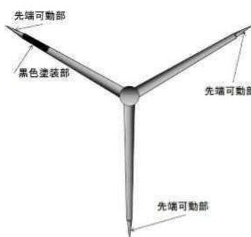
図-11 検証実験におけるブレードの彩色例 (黒色、先端部彩色)
