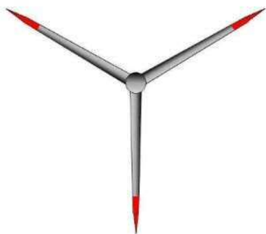
図-8 3枚のブレードの彩色例 (赤色、先端部彩色)
