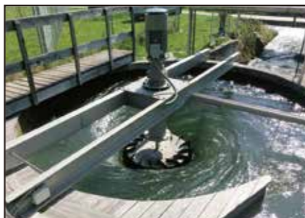
低落差の水路に設置可能で、魚などが通過することができる環境配慮型。
