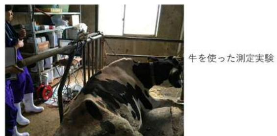
私は、ワイヤレス通信用信号処理技術の研究に 20 年にわたって従事してきました。その成果を、ワイヤレス通信と同様に電波を使う生体計測技術に応用することで、斬新なアイデアを提案しています。特長として (1) 極めて簡単で、(2) 複数の人・動物を同時に計測でき、(3) 心拍・呼吸の瞬時的変化を掲出でき、(4) 心拍・呼吸だけでなく、測定対象の方向も同時に検出できることなどの点があります。これらの特長は、世界的にも例を見ません。
