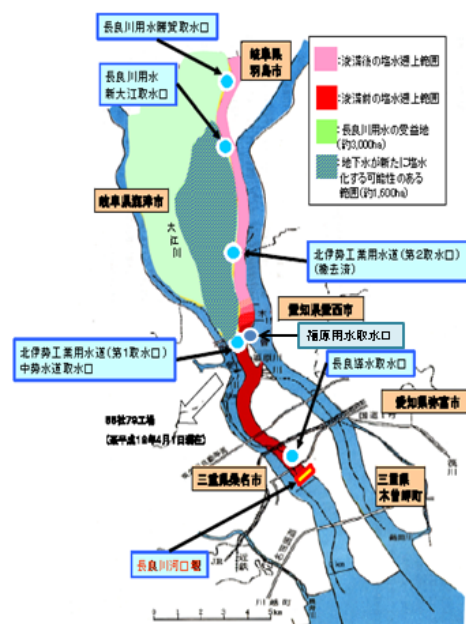
図2 長良川下流部の取水口 (国交省・水機構資料に福原用水を追加)
