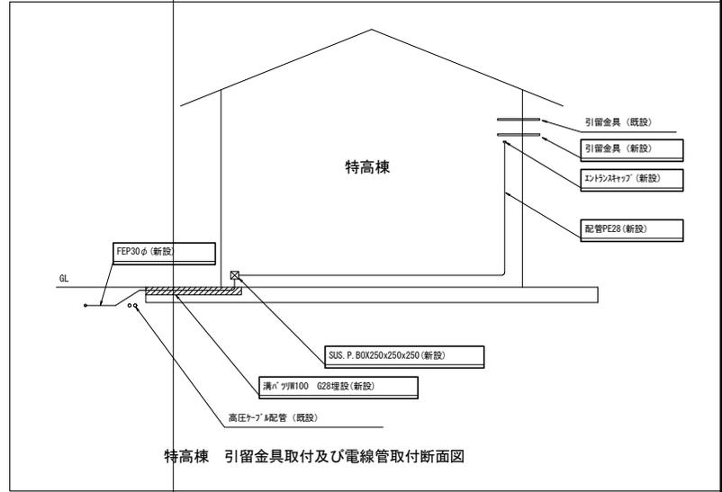
特高棟 引留金具取付及び電線管取付断面図
