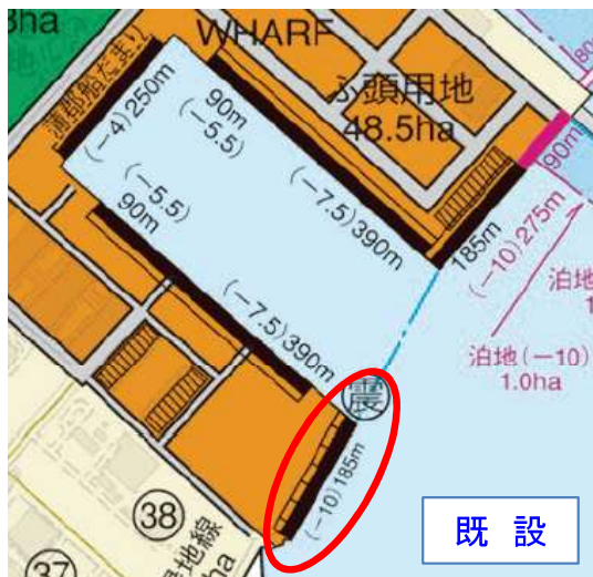
三河港の耐震強化岸壁整備状況 (蒲郡地区)
