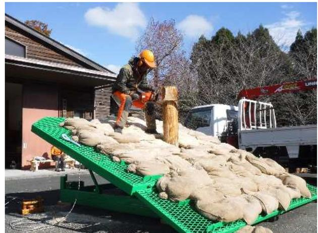
傾斜型伐倒練習機
