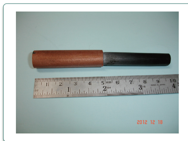
図1 C-FRP丸棒への銅厚膜創成例
