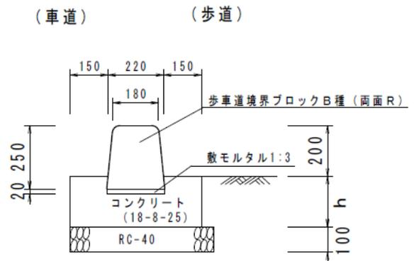
詳細図の寸法 h は、既設舗装にカッターを入れて設置する場合の寸法として h=12cm とする。
