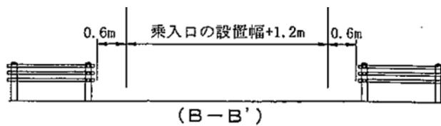
ガードパイプは乗入口の設置幅+1.2mから0.6m控えて設置する。
