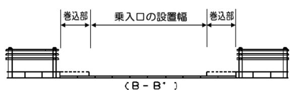
ガードパイプは乗入口の設置幅から巻き込みの範囲を控えて設置する。
