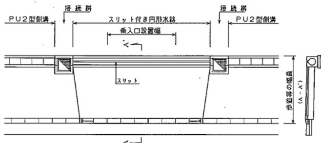
C型乗入口の側溝は、左図のようなスリット付の円形水路等、蓋の無いものを使用する。
