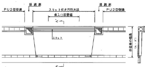
C型乗入口の側溝は、左図のようなスリット付の円形水路等、蓋の無いものを使用する。
