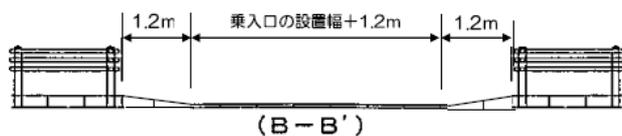
ガードパイプは乗入口の設置幅 + 1.2m から 1.2m 控えて設置する。
