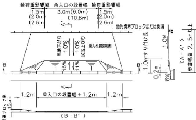
民地側に側溝が設置されていない場合は、民地下がりを適用しない。防護柵の設置箇所における撤去範囲は下に記載のとおりとする。
