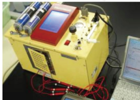
GCと半導体ガスセンサを搭載した試作機
