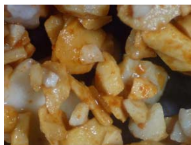
<洗浄・消毒前の汚れたろ材>
