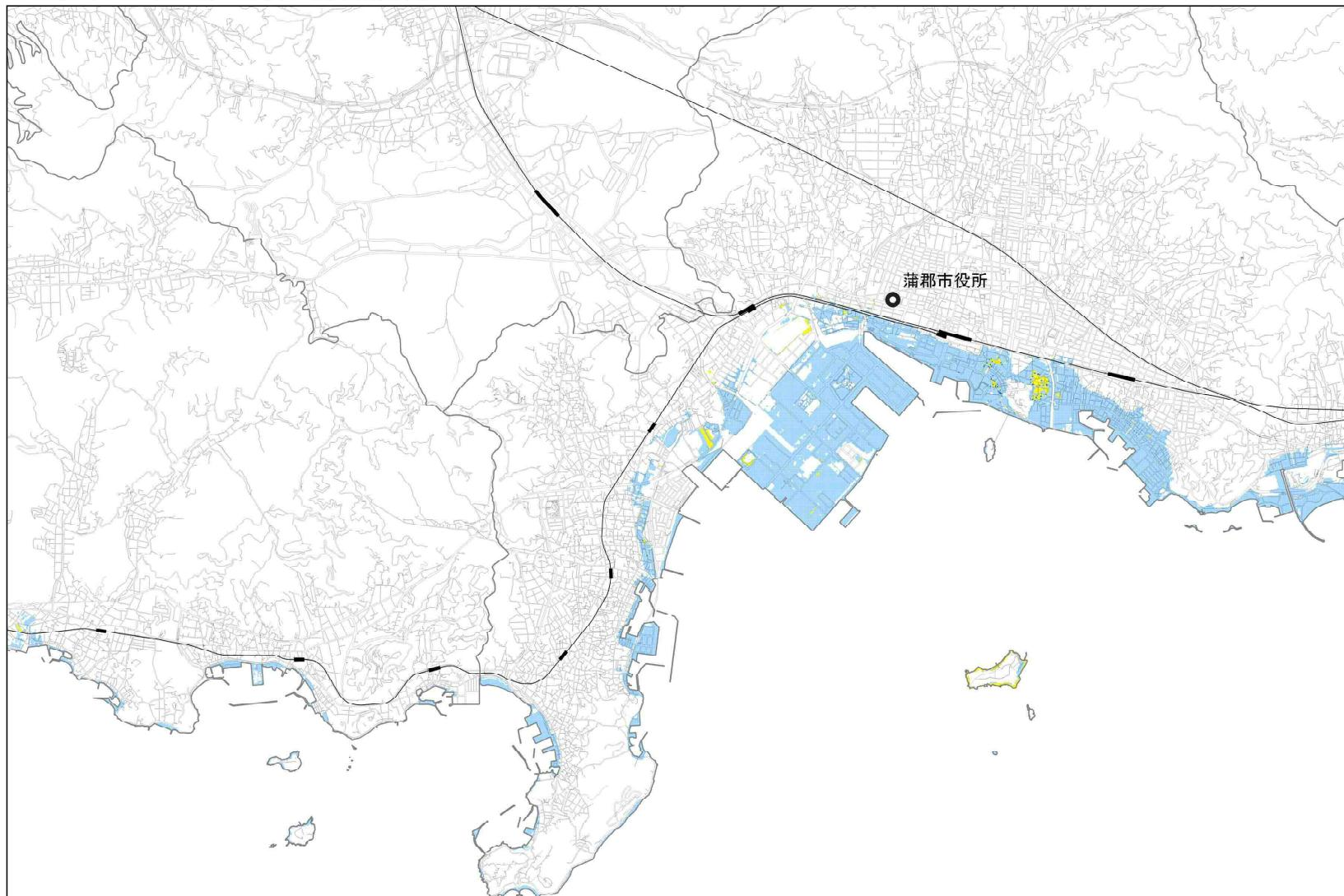
この図は、高潮浸水予想図(伊勢湾台風規模・堤防等決壊なし)（日本に上陸した既往最大台風である室戸台風の気圧を有する台風が、三河湾・伊勢湾沿岸に大きな影響を与える経路を複数設定し、堤防・水門等が機能した場合の条件で高潮シミュレーションを実施したもの）の0.5m以上の浸水が想定される区域。想定される浸水継続時間を表示したものです。
