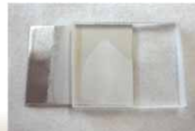
マグネシウムとアクリル樹脂のレーザー接合
