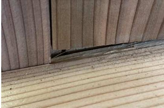
図-15 板のめり込み（試験体 3）
