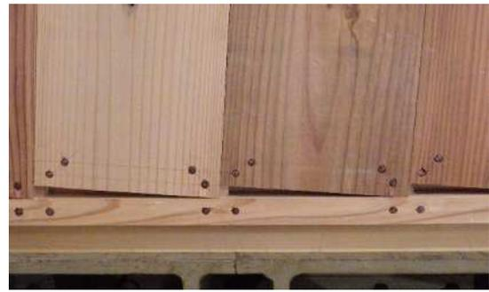
図-23 板のめり込み（試験体 7）
