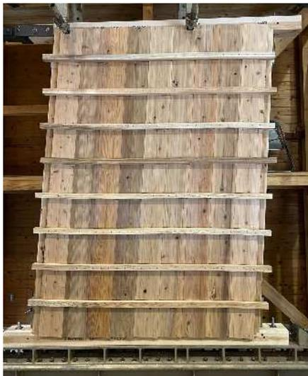
図-16 試験体 3 の S 字に曲がった根太
