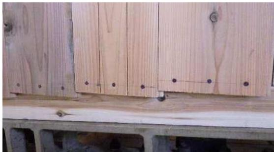
図-13 試験体 1 の板間の滑り
