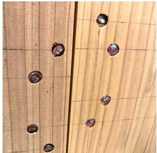
図-18  $30^\circ$  に配置した釘のめり込み（試験体 5）
