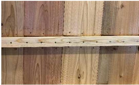
図-21 板のめり込み（試験体 6）
