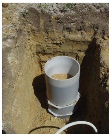
図1 埋設したキャピラリーライシメーターの外観
