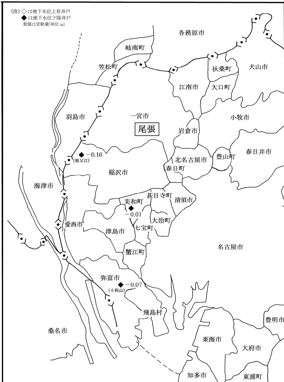
図-13 G1層の地下水位変動状況
