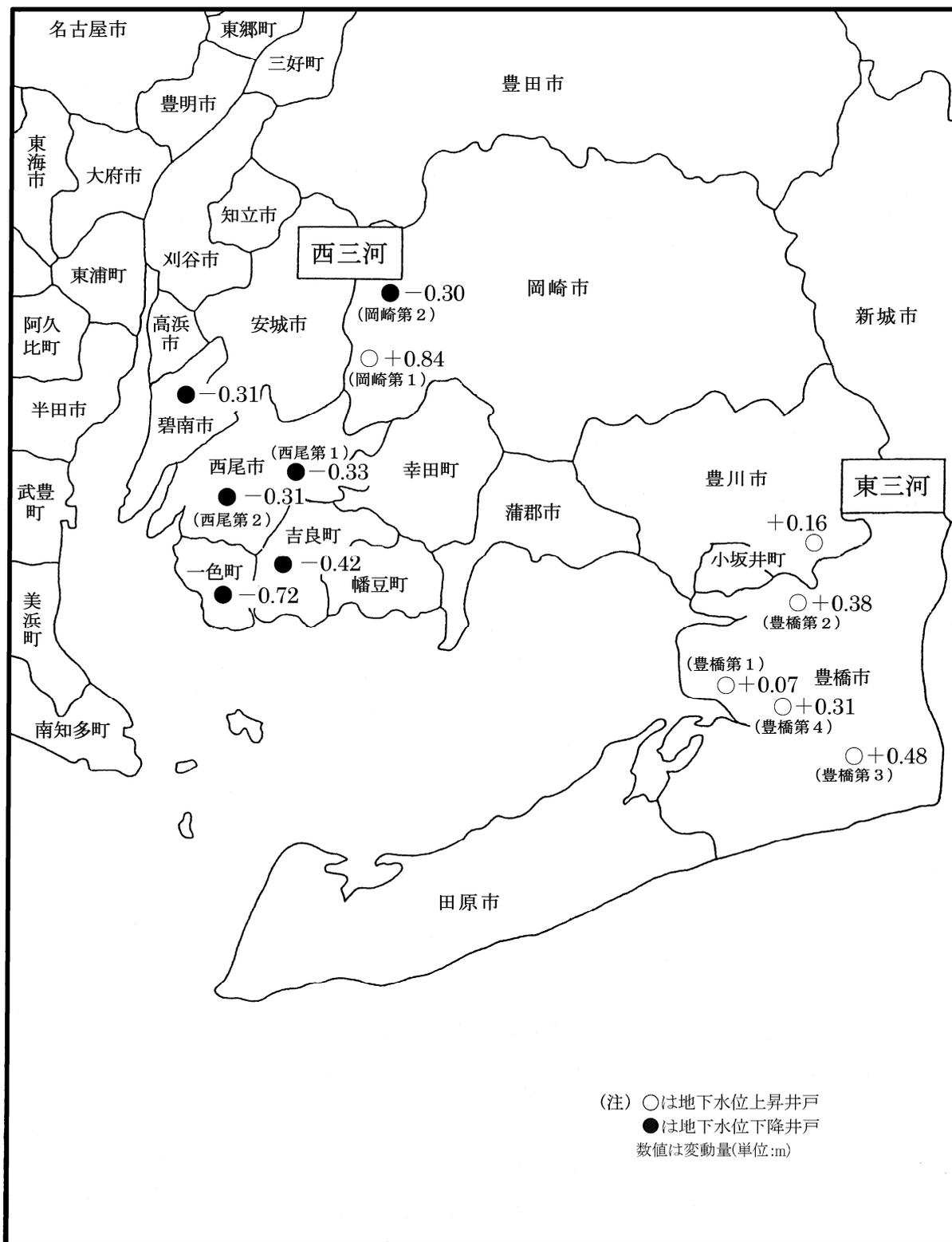
図-20 年別地下水位変動状況（吉良地盤沈下観測所）
