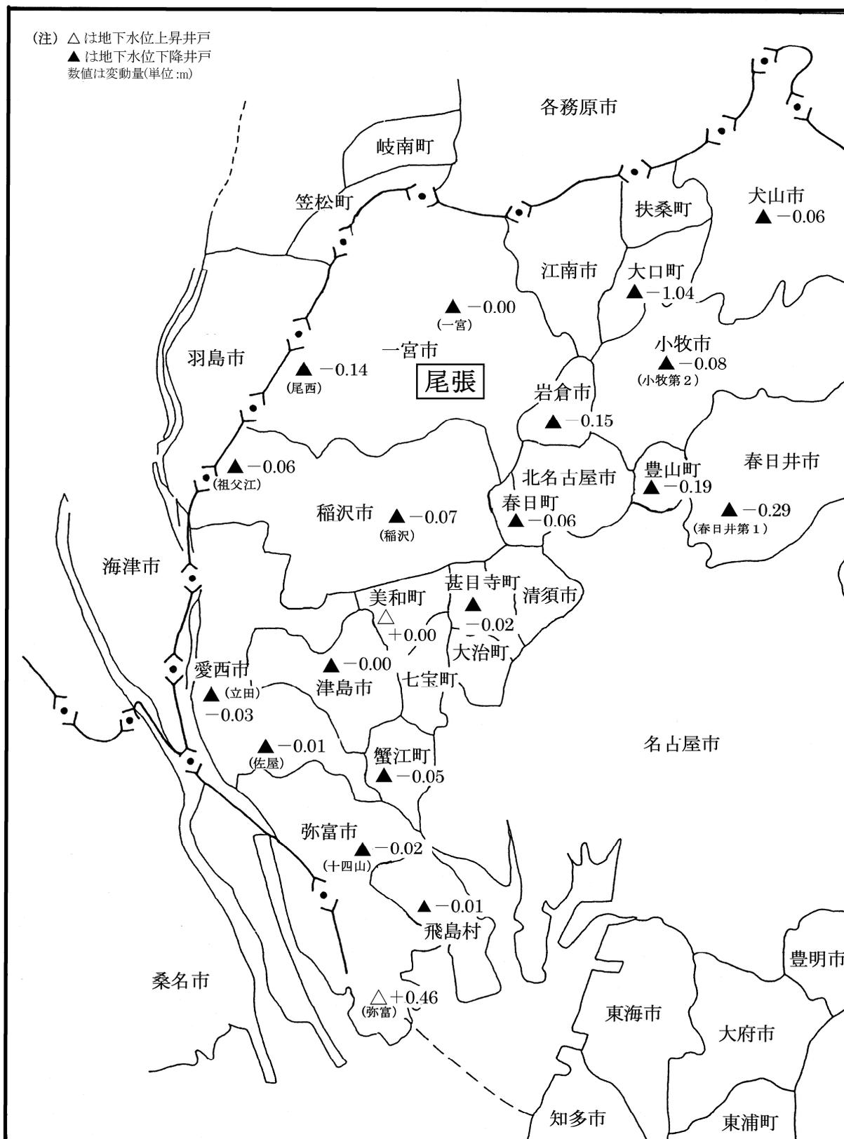
図-14 G2層の地下水位変動状況
