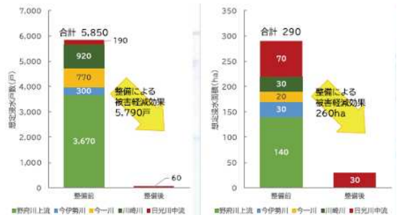
日光川2号放水路整備による被害軽減効果 (年超過確率1/5の規模)
