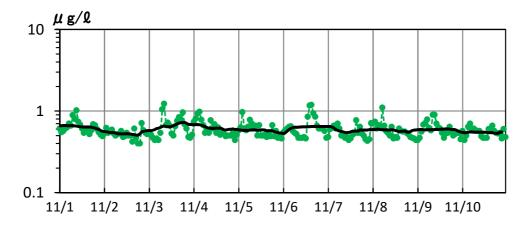
豊浜地先(34°42.05′N、136°56.85′E、DL-3m)の毎正時観測値 実線は25時間移動平均
