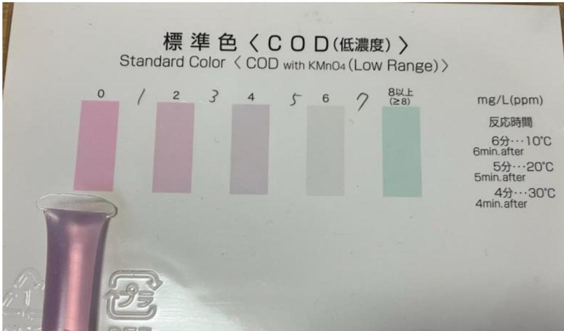
図12 COD反応（雨水）
