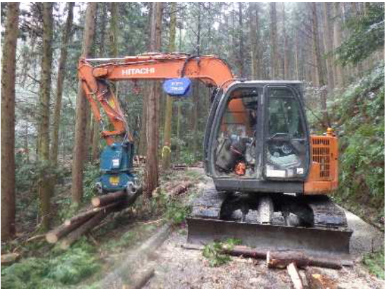
グラップルによる集材（岡崎市） ※アーム先端に丸太を掴める器具を装着した荷役機械
