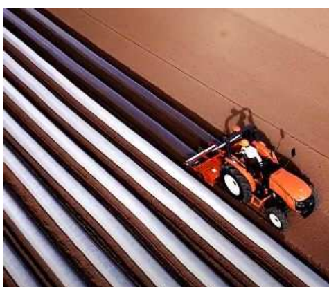
GPS操舵システムを導入したトラクターによる効率的な畝立て
