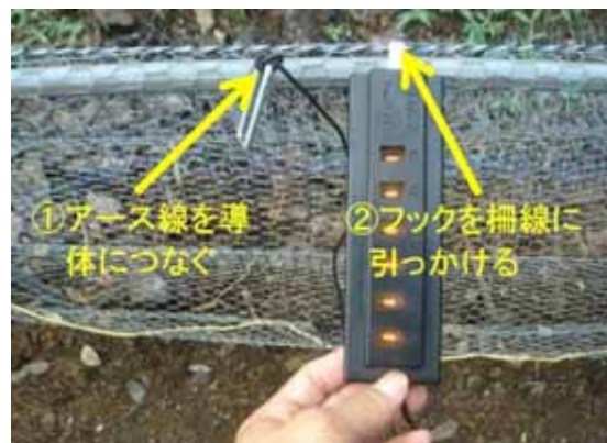
写真3 専用テストによる電圧確認
