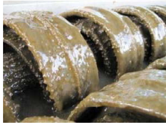
写真2 汚泥（微生物）が接触材の表面に付着している
