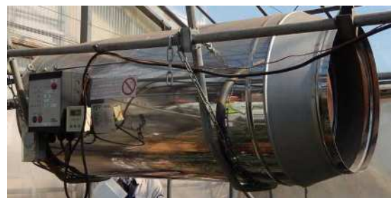
試験導入した炭酸ガス発生装置
