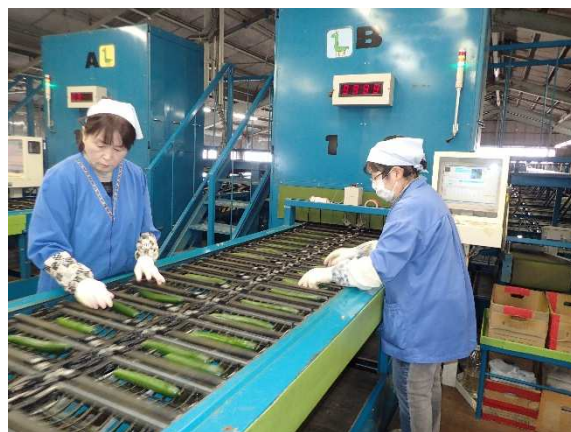
新選果機の表示板には現在のラインの充填率が表示される。生産効率を常にチェックする、工業界のノウハウを取り入れたもの。
