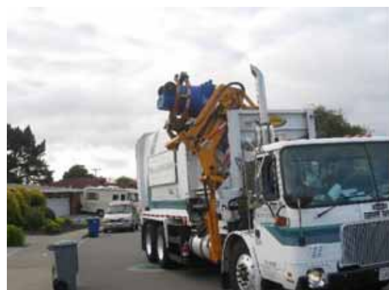
家庭ごみの収集の様子2（ごみを荷台に入れる）
