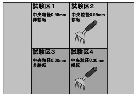
図 1 平面水槽における試験区の設定
