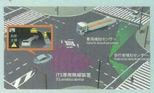
通信利用型レーダークルーズコントロール Communicating Radar Cruise Control
