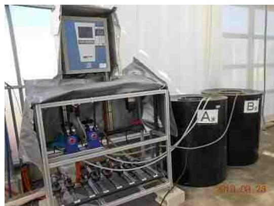
給液ユニット(タンクと施肥・かん水制御機器) (日本オペレーター製)
