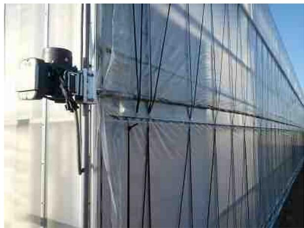
側窓巻き上げ装置(日本オペレーター製)
