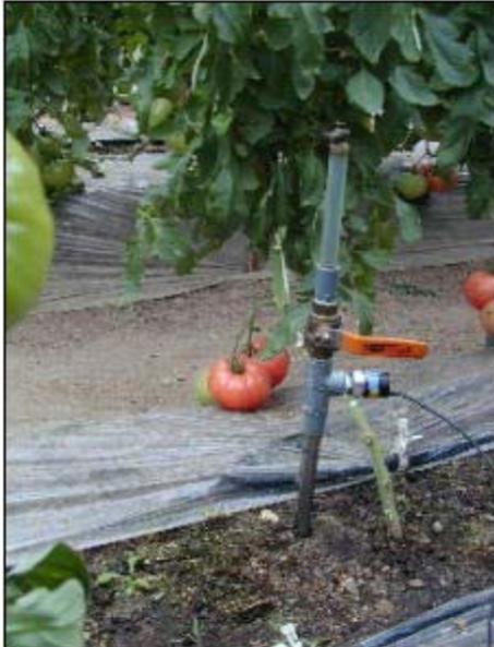
圧力変換器付きテンションメータの設置
