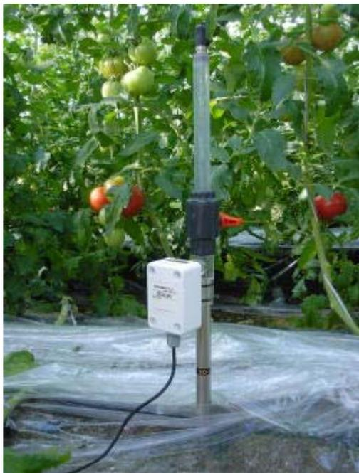
圧力変換器付きpFセンサーの埋設
