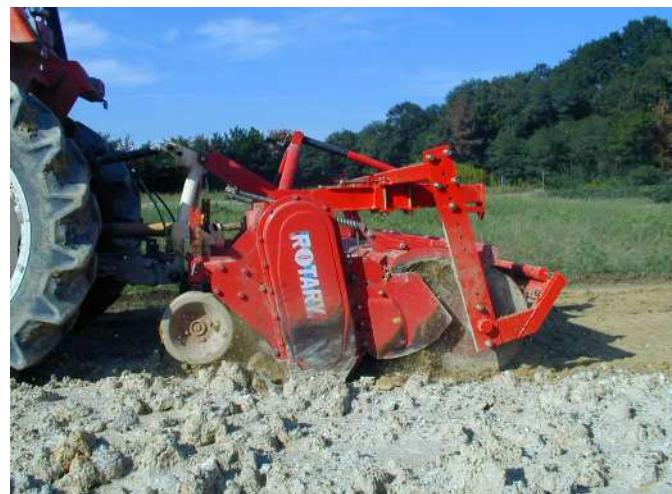
図10 浅耕鎮圧機の作業状態
