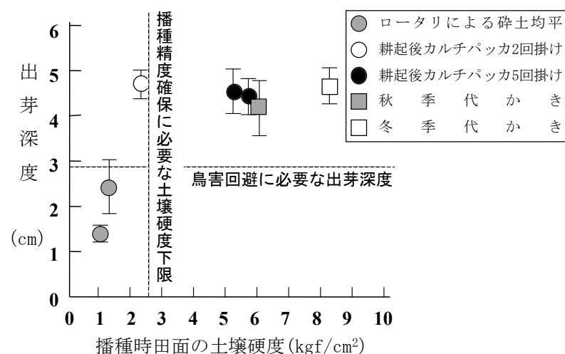
図 14 整地の方法が播種時の土壤硬度に及ぼす影響
