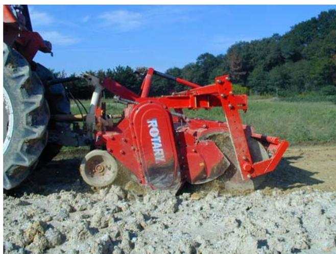
図10 浅耕鎮圧機の作業状態
