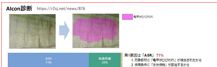
図 3-12 AI による損傷要因特定例
