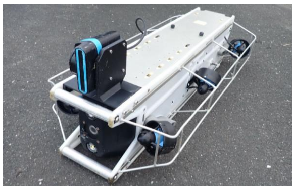
写真 3-12 使用機械 ・産業用水中ドローン ・DiveUnit HAYATE
