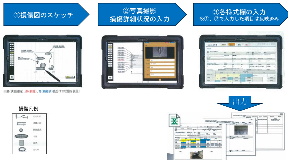
図 3-11 タブレット端末による調書作成のシステム例
