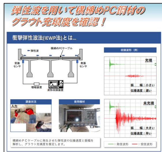
図 2-15 グラウト充填調査例
