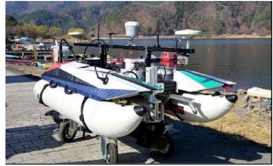
写真 3-11 使用機械 ・ 小型無人ラジコンボート ・ ナローマルチビーム測深機
