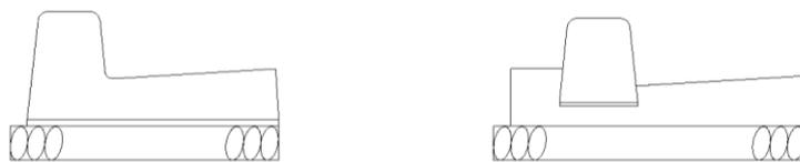
(b) L型側溝の例
