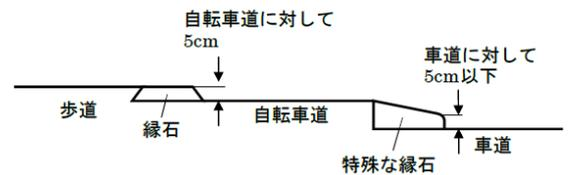
図 12.1 自転車道の分離構造の例
