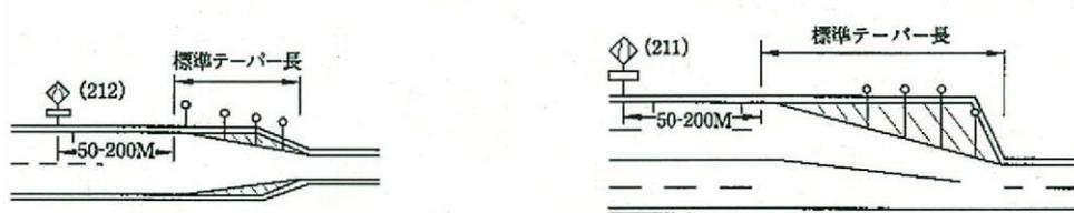
図 11-1 起終点で幅員(車線)差が生じる場合
