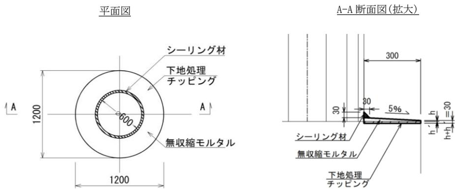
図 3-31 天端面の補修構造(既設形状：円形)
