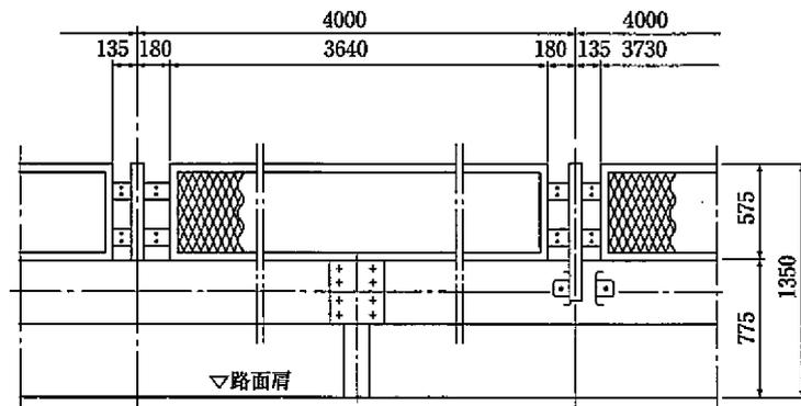
図 2-6 ガードレール部 (マウントアップしない中央分離帯の場合)
