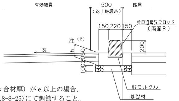
注(1) ベース付歩車道境界ブロックは、車道舗装 (As 合材厚) が  $e$  以上の場合、 $e \geq As$  合材厚となるよう、均しコンクリート (18-8-25) にて調節すること。
