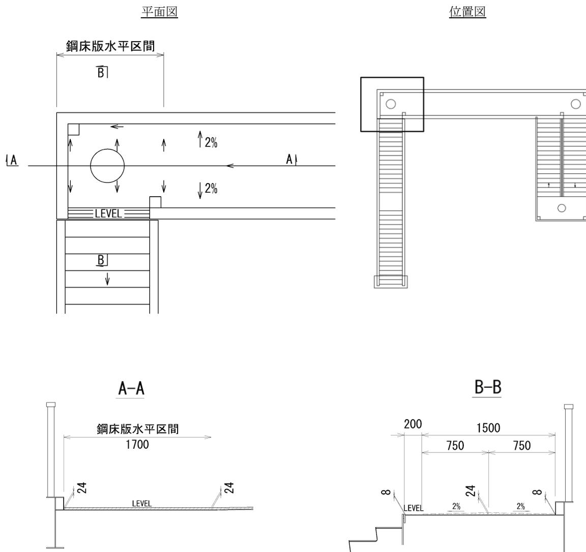
図 3-26 舗装による導水勾配(コ型 通路部)
