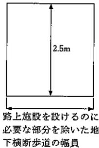
図 3.16 地下横断歩道の建築限界
