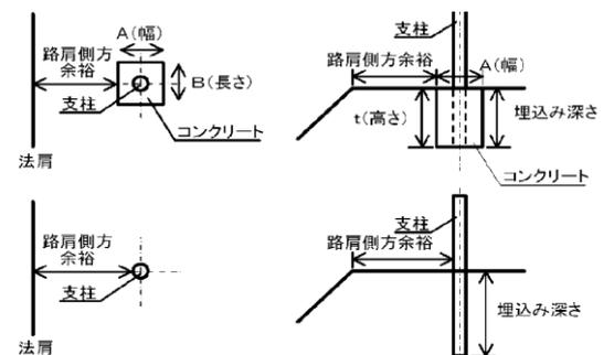
図 5-10 根固め寸法および路肩側方余裕
