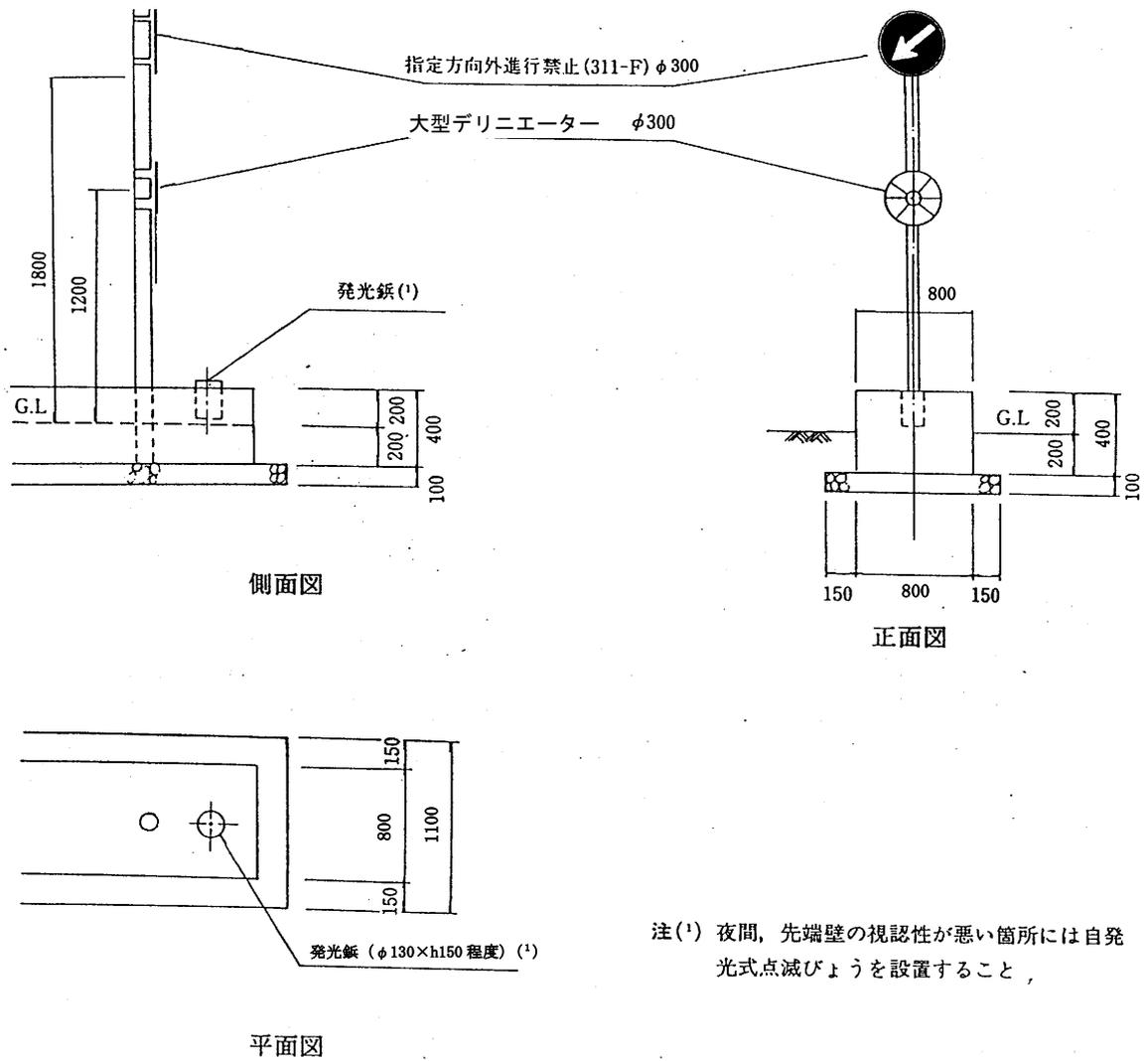
図 2-3 先端壁が設置できない場合の対策(参考図)
