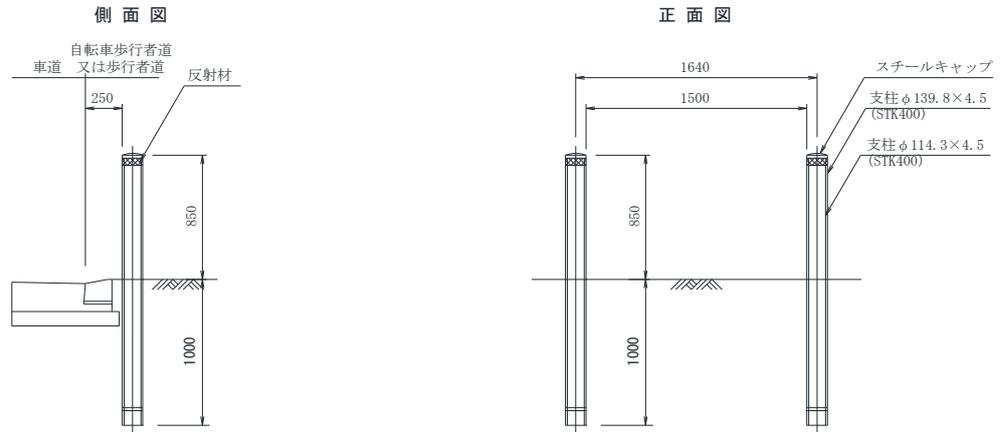
図 5-18 構造仕様例(H型ポラードの土中式)
