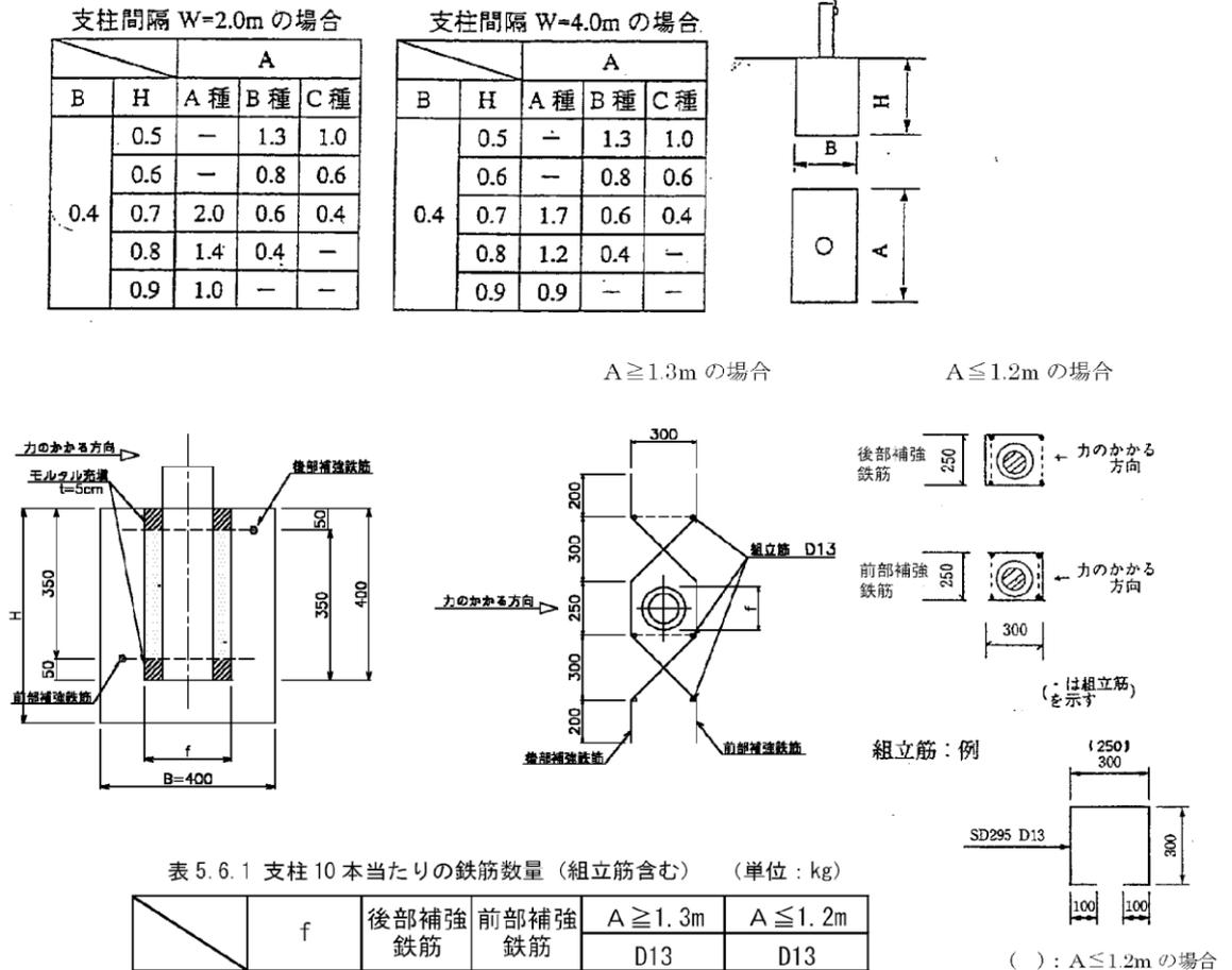
補強鉄筋 A ≥ 1.3m L=(0.20+0.42)×2+0.25=1.49m
