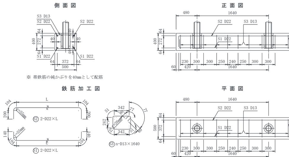
※ 帯鉄筋の純かぶりを40mmとして配筋
