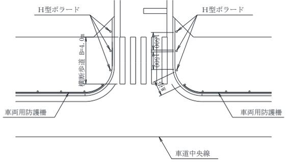
注) ※の箇所は現地状況に合わせて、1.0m~1.5mの範囲で適宜設定する。
