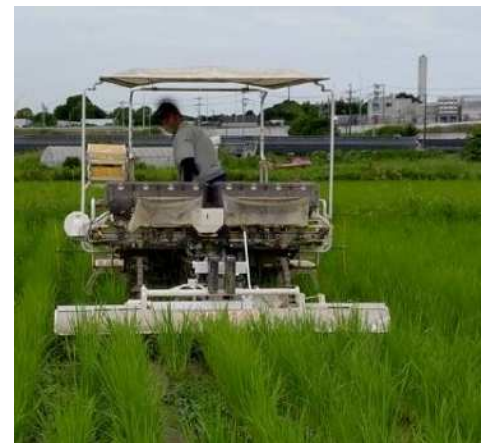
写真 1 水田除草機による除草作業
