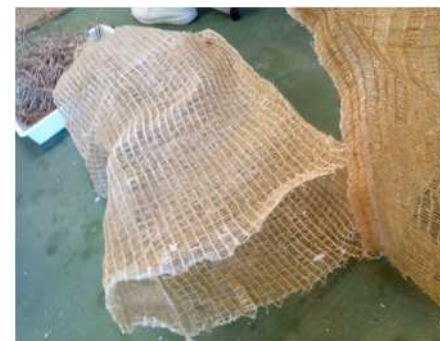
図1 開発した生分解性袋網
