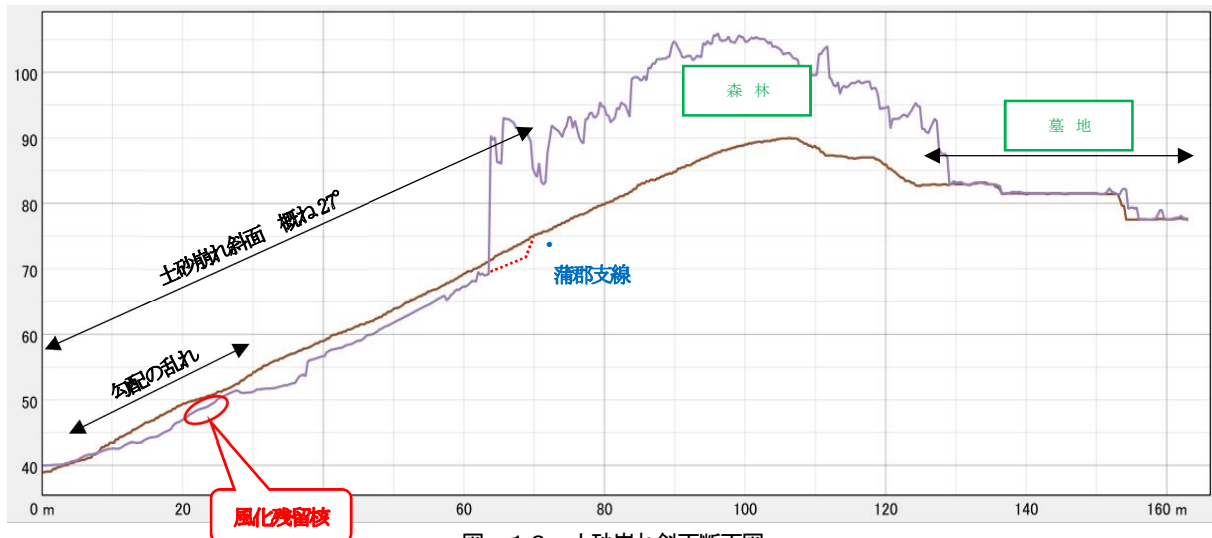
図－1 6 土砂崩れ斜面断面図
