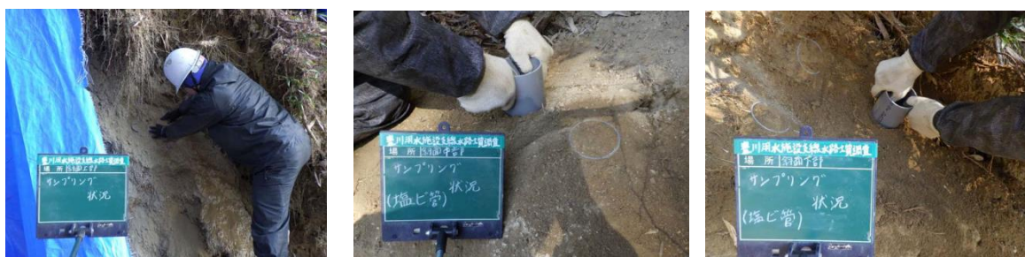
写真－1 サンプルング状況（左から斜面上部、斜面中部、斜面下部）
