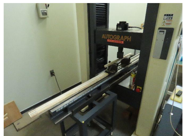
早生樹試験片の強度性能評価
