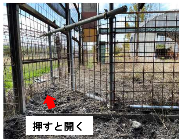
開発した新型わな イノシシが鼻で押すと扉が開く
