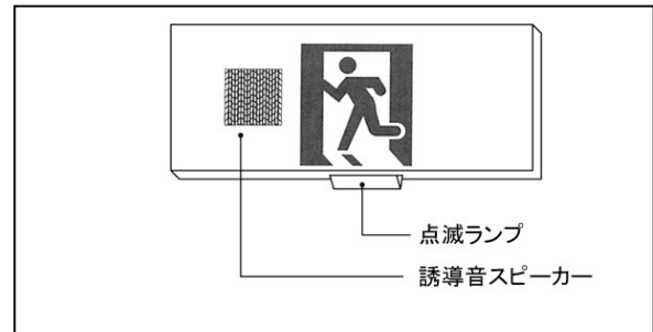
視覚障害者に配慮した誘導音付の誘導灯
