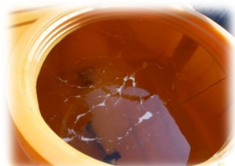
タンク内の通気量の目安
