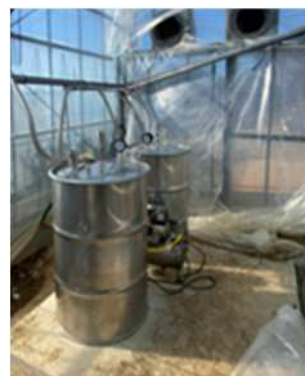
工場で回収したCO 2 を 貯留したドラム缶
