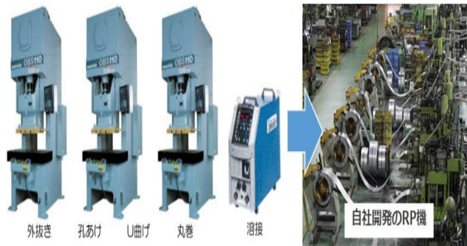
一般的な板巻きパイプ加工に必要な作業機械との比較
