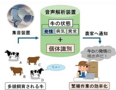
〔成果例〕牛の発情を検知し通知するシステム
